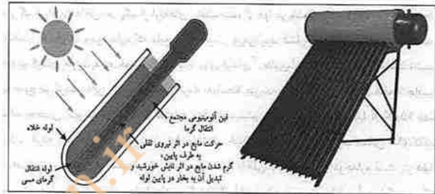
شکل ۹۷ کلکتور لوله‌ای تخلیه‌شده (خلل‌دار) - نوع تمام‌شیشه
