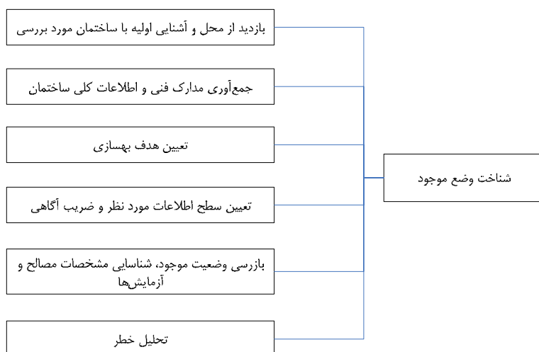
شکل (۱-۱): مراحل شناخت وضع موجود
