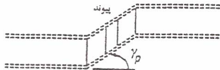
شکل (ت ۵-۴): زاویه‌ی چرخش تیر پیوند
