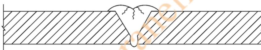
شکل ۱۷-۵-۶-۳-ب ترک های ستاره ای در سطح جوش.
