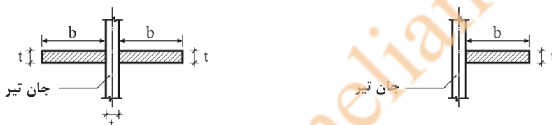
شکل ۱۰-۲-۶-۱ مقطع سخت‌کننده‌های عرضی
