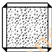
(ب) عضو محوری مختلط قوطی شکل پر شده با بتن
