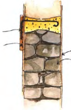
شکل ۹-۱۰ گل میخ‌های برشی برای نصب تسمه لرزه‌ای
