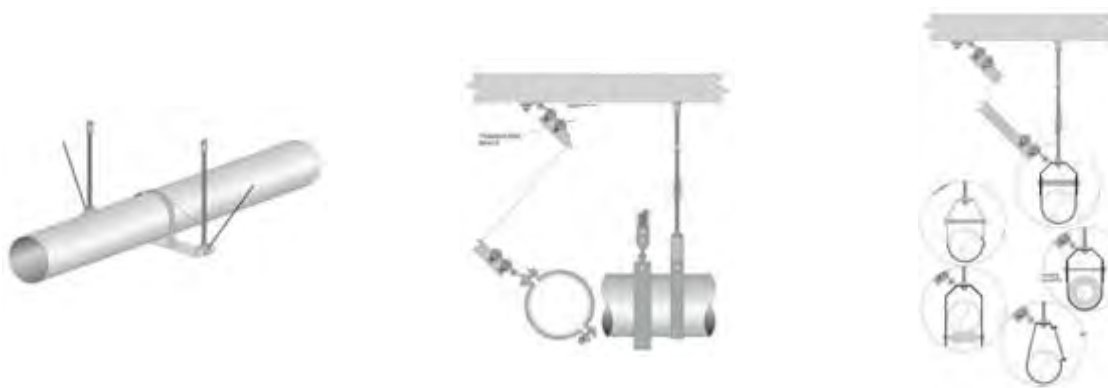
شکل ۱۰-۲۱- مه‌ارهای جانبی برای لوله‌ها
